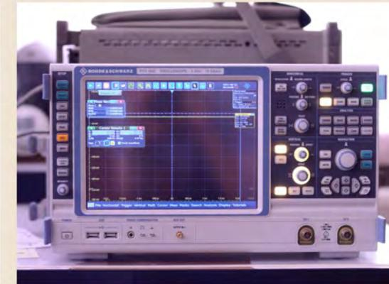
**Осциллограф цифровой запоминающий R&S RT01022 с полосой пропускания 2 Гц**
