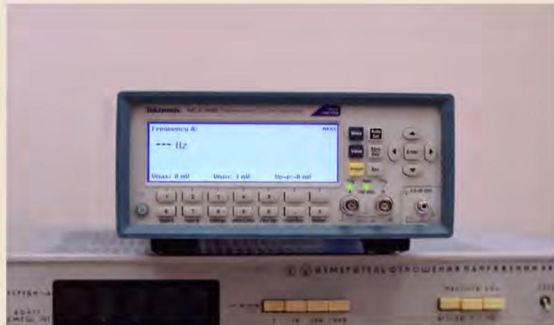
Частотометр универсальный МС3040
