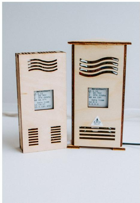
**Пилотные образцы прибора имели прямоугольный корпус в двух вариантах исполнения: с дисплеем, что дает возможность пользователю воспринимать информацию и визуально, и без вывода показаний на дисплей (этот вариант предназначалась для применения в помещениях хранения). Обе модификации обладают возможностью передачи данных посредством Wi-Fi.**
