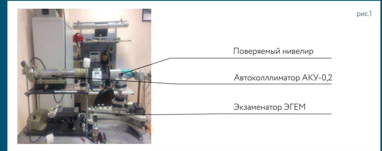
В настоящее время при работе с данным измерительным устройством оператор выполняет оптическое снятие отсчета по сетке нитей автоколлиматора, снабженной микрометром. Вид поля зрения автоколлиматора АКУ-0,2 представлен на рисунке 2.
