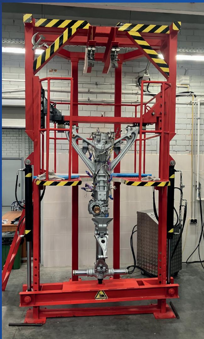
Стенд сборочно-разборочный предназначен для проведения технического обслуживания и ремонта стоек шасси воздушных судов, позволяет выполнять специфические функции по обеспечению сборки-разборки и центрированию крупногабаритных гидравлических цилиндров опор шасси, а также их тестированию на финальном этапе после завершения регламентных работ для воздушных судов семейства Airbus (A319, A320, A321).
