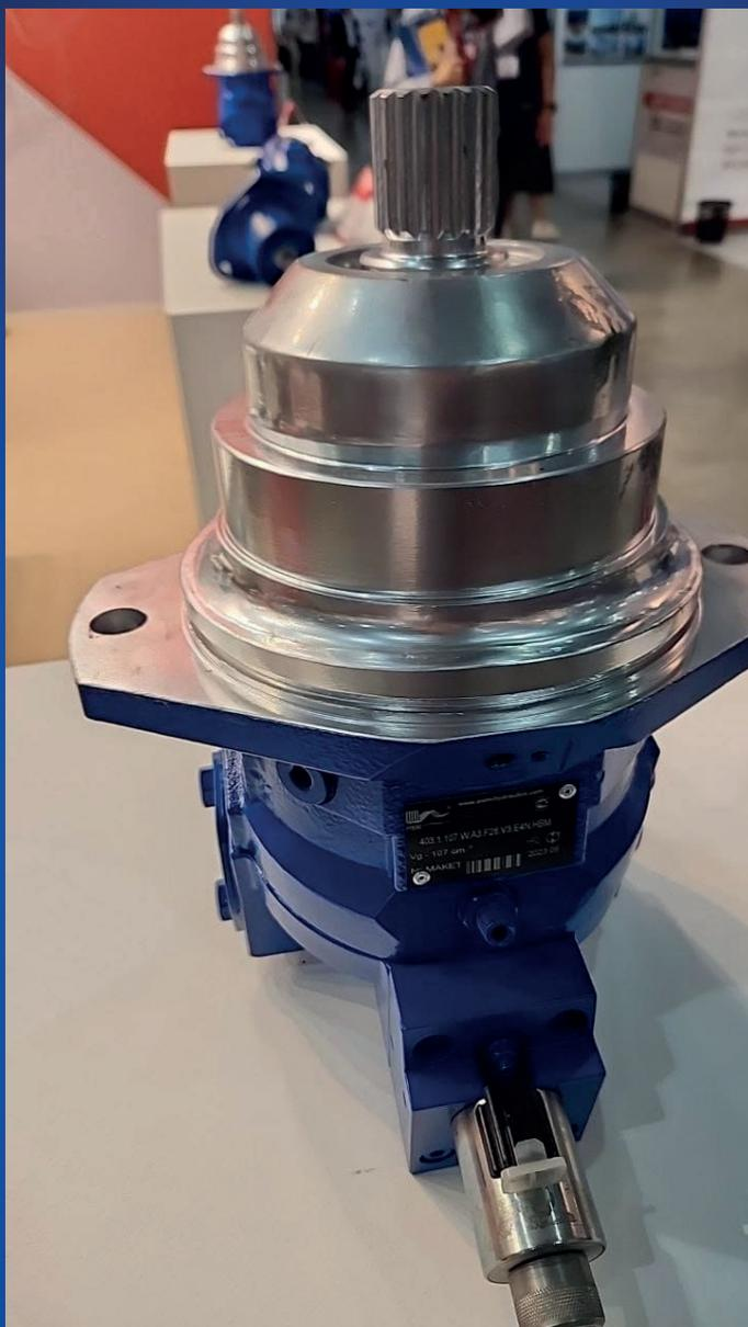
Гидромотор аксиально-поршневой 403.1.107.W.A3.F28.V3.E4N. HВ.F.U (с наклонным блоком, реверсивного вращения, регулируемый, встраиваемое исполнение (картриджное)) преобразует гидравлическую энергию потока рабочей жидкости в механическую энергию вращения вала. Гидромоторы предназначены для работы в открытых и закрытых гидросхемах стационарных и мобильных установок. Конкурсная продукция одобрена Российским регистром морского судоходства.
