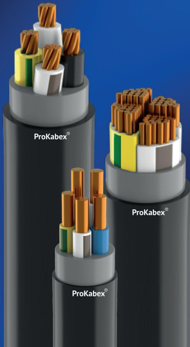
Кабели силовые с медной токопроводящей жилой предназначены для передачи и распределения электрической энергии в электротехнических стационарных установках на номинальное переменное напряжение 0,66, 1 и 3 кВ частотой 50 Гц. Кабели Prokabex – это импорто-замещающая кабельная продукция, для производства которой используются высокотехнологичные и экологически безопасные материалы.
